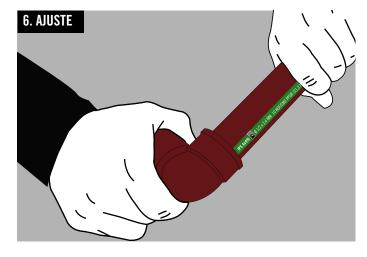
Presentar la conexión en el tubo y roscar hasta que haga tope. Para medidas chicas ajustar manualmente.
