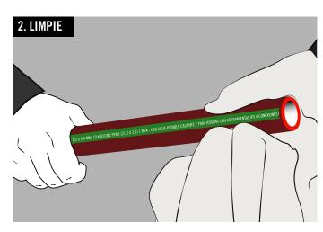
Libere de polvo y grasas la superficie a roscar. Evitar que queden rebabas. Puede utilizar trincheta o cutter para tal fin.
