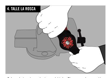
Colocar la terraja en el extremo del tubo. Ejercer una leve presión para que la mordiente de la herramienta calce sobre la capa del tubo. Hacer el primer giro con una mano y los siguientes con ambas.
