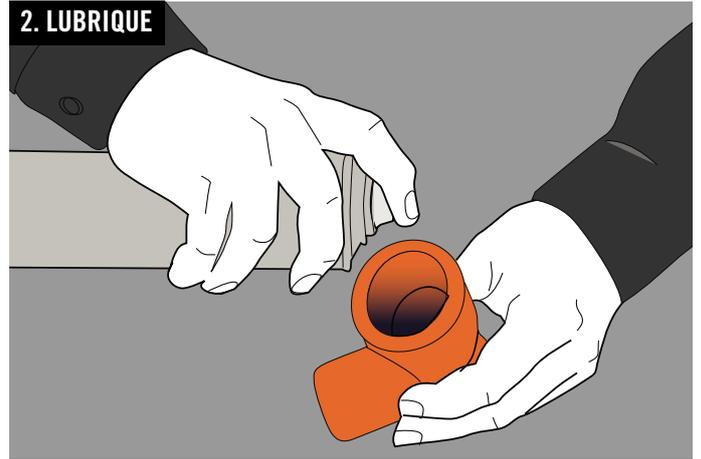
Aplicar la solución lubricante IPS sobre el extremo hembra.
