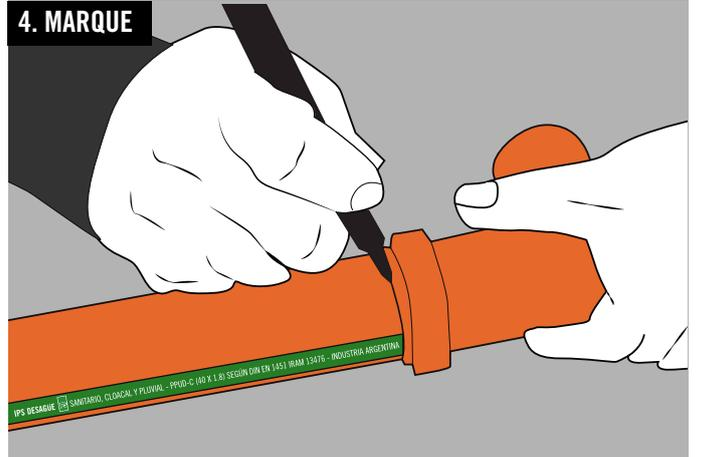
Luego de haber introducido el tubo en la conexión, se deberá retirar 1 cm; para ello marcar previamente sobre el tubo.
