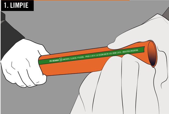
Para una correcta lubricación, se deben limpiar los extremos macho y hembra.
