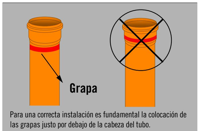
Para una correcta instalación es fundamental la colocación de las grapas justo por debajo de la cabeza del tubo.
