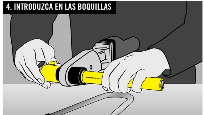
Verifique que la termofusora se encuentre a temperatura de trabajo e introduzca simultáneamente tubo y conexión en las boquillas, manteniendo el tiempo indicado (ver tabla A).
