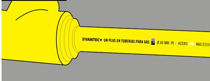
Respete el tiempo de reposo antes de someter la unión a movimientos (ver tabla A). La fusión correcta se identificará por la formación de los anillos sucesivos producto del barrido del material.
