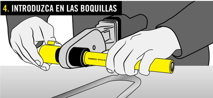
Verifique que la termofusora se encuentre a temperatura de trabajo e introduzca simultáneamente tubo y conexión en las boquillas, manteniendo el tiempo indicado (ver tabla A).
