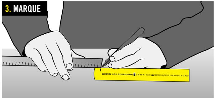
Marque en el tubo la longitud de penetración de la boquilla (Ver tabla A en la pág. 13).
